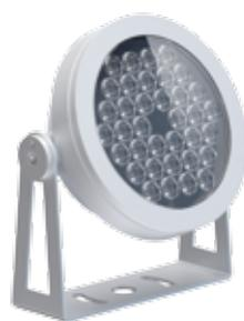
**Abb.:** Acht LED-Strahler »P200« von ewo wurden für das Kunstobjekt eingesetzt. Das Glas ist satiniert, die Farbtemperatur liegt bei 3000 K, die Leistung bei 72 W. Die Konstruktion führte Lanz Metall aus. Bild: ewo
