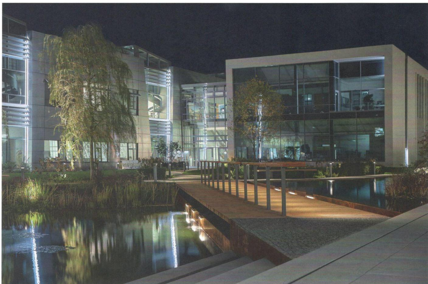
▲ In die Stützen der Handläufe integrierte Einzel-LEDs verteilen ihr Licht dank spezieller Linsenoptik fächerartig auf dem Steg und heben den warmen Holzton hervor. Unterwasser-Lichtlinien inszenieren die Dynamik des herabfließenden Wassers.
